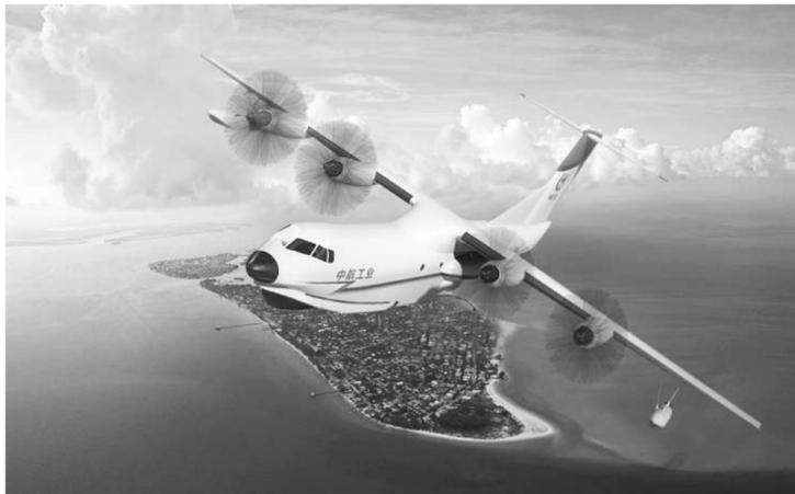
AG600飞机按“水陆两栖、一机多型、系列发展”的设计思路,采用单船身、悬臂上单翼布局及前三点可收放式起落架,选装4台WJ6发动机,最大起飞重量53.5吨,20秒内可一次汲水12吨。该
