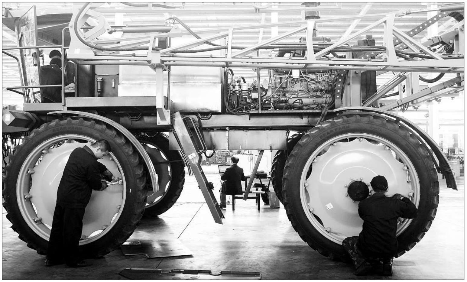
日前,集施肥、播种、喷药等多种功能于一身的农业植保机器人在山东潍坊滨海区华创机器人制造有限公司进入批量生产阶段。据悉,该机器人可对玉米、大豆、棉花等农作物进行护理,机器人配备了四轮驱动系统,可实现四轮转向,转弯半径仅为7.5米,臂展最长38米。图为工作人员在流水线上装配植保机器人。 新华社发(孙树宝摄)
