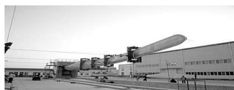
叶片全尺寸型式试验台
