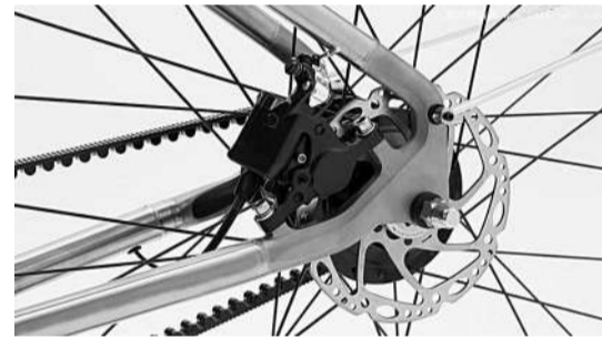
3D打印制成的钛金属自行车(局部)
