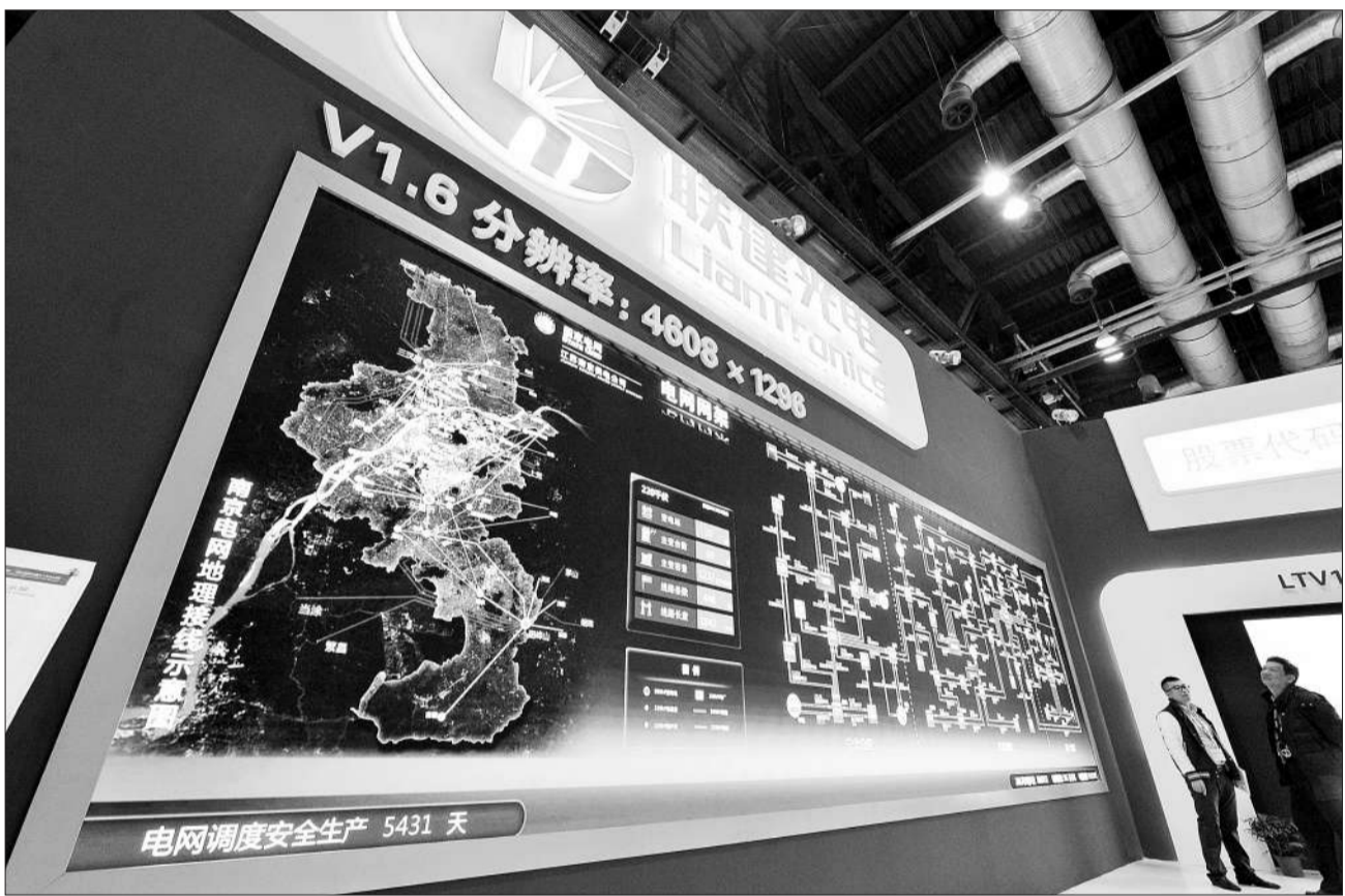
4月9日,北京国际视听集成设备与技术展览会开幕,来自国内外的上百名参展商展示了视听技术领域的最新技术和产品。图为深圳联建光电股份有限公司推出的最新小间距LED显示系统。该系统具有多屏图像处理核心,可提供足够的分辨率支持和画面多样组合功能,应用于会议、指挥、调度、监控等领域。
