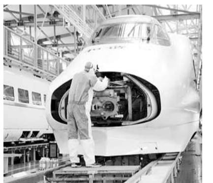
为保证动车组安全优质上线运行,提高旅客出行满意度,重庆车辆段充分利用好春运后至暑运前的春季整备“黄金期”,不断加大动车组服务设施的专项整治力度,同时强化车底悬挂部件、制动配件及受电弓等重点部位检查以及轮对探伤管理,确保动车组“健康”出行。图为动车机械师正在进行车钩检修工序。陈亚摄
