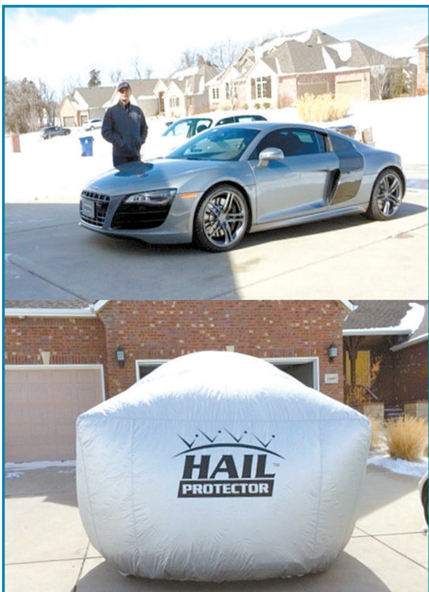
美国男子Michael Siciliano发明了一个防止冰雹砸坏汽车的气囊,该气囊重量只有1千克,充气五分钟即可使用。气囊的使用十分灵活,既可以用于小型汽车也可以用于大型卡车。
