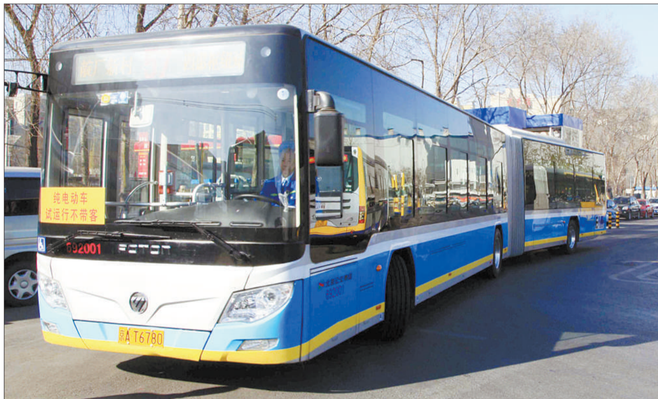
3月23日,一款18米长的巨型纯电动公交车在北京公交57路投入空载试运行,预计25日开始载客试运营,最大载客人数可达143人。车内采用的磷酸铁锂电池,一次充电在城市路况下运营里程可达100公里以上。新华社发
