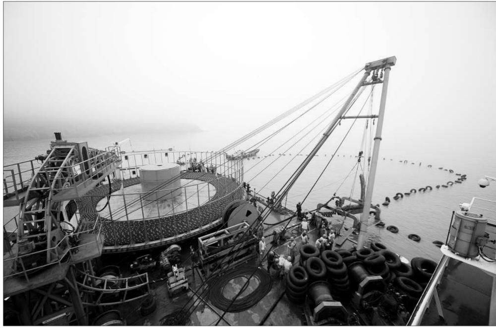
近日,目前国内单根长度最长(38公里)、电压等级为110千伏的交流光电复合海底电缆成功登陆洋山岛。至此,舟山蓬莱(岱山)至沈家湾(洋山)110千伏海底电缆建设工程基本告捷,它将成为洋山岛的主电源,解决洋山岛原先电网结构不够坚强的难题,助推洋山岛经济社会发展,也将成为西礁本岛和洋山港区的重要电源点。
