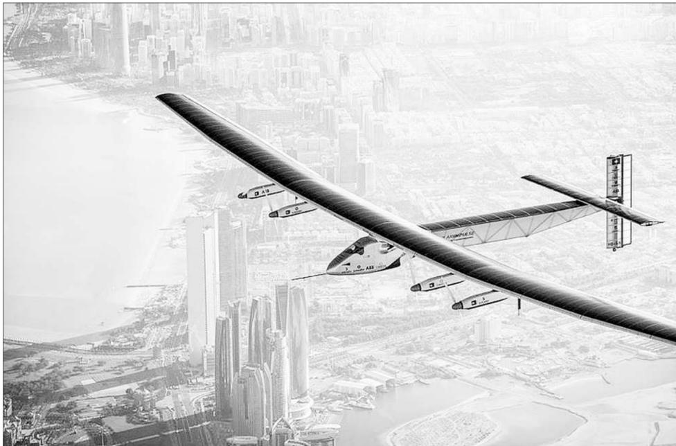
机翼有144根间隔为50厘米的翼肋,机翼上表面由17248个厚度仅为135微米的单晶硅太阳能片覆盖,下表面由一种极轻的织物材料包裹,翼梁则由蜂窝状碳纤维叠层构成。太阳能电池板上覆有一层厚度仅为17微米的含氟共聚物树脂薄膜,用于保护电池板抵御紫外线和水的侵蚀。
