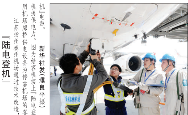
新华社发(濮良平摄) 机一电源。图为给客机上“陆电”登机提供电力。图为给客机上“陆电”登机提供电力。图为给客机上“陆电”登机提供电力。
