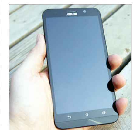
华硕ZenFone系列第二代产品——ZenFone2,号称是全球第一款采用4GB运行内存的智能手机。顶配版本ZenFone2被冠以性能怪兽的称号,它还采用了Intel Moorefield平台的首款处理器Z3580。在侧边设计上有着非常明显的弧度,最薄处只有3.9mm。
