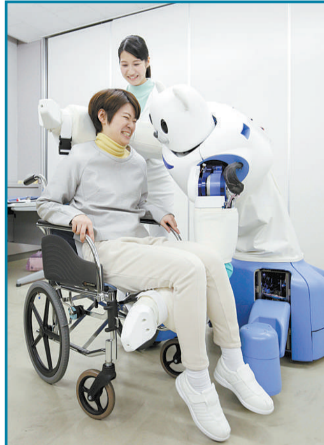
日本理化学研究所和住友公司的科学家研发出一款新的实验护理机器人。它可以将病人从床上搬到轮椅上,或帮助病人站起来。
