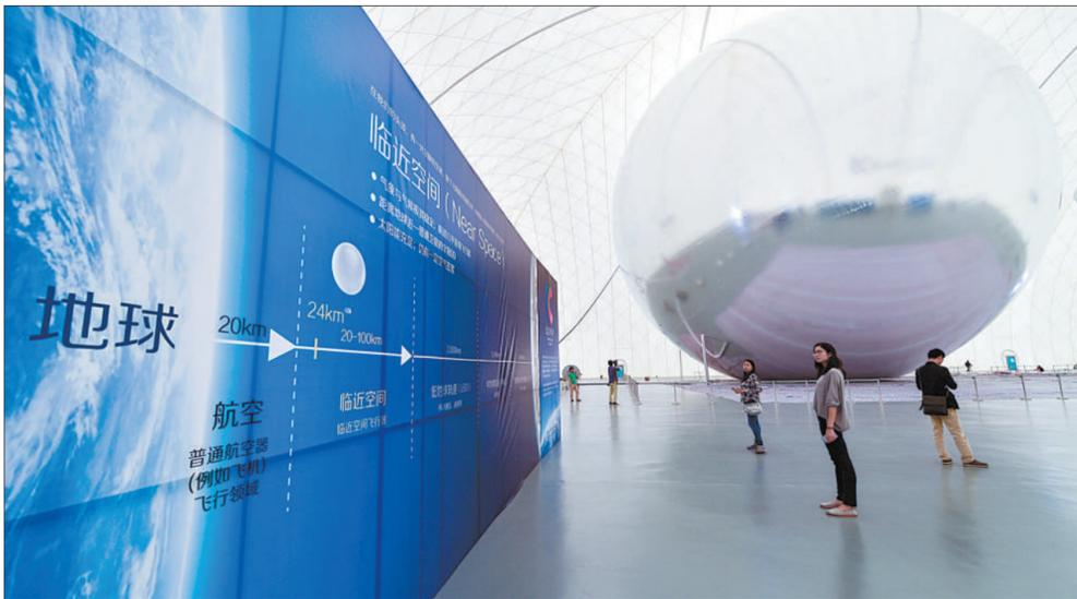
3月17日,参观者在深圳龙岗的光启阿波罗基地观看充气后的临近空间飞行器“旅行者”号。“旅行者”号球体直径约40米,充满氮气后总重量超过1吨,将飞行在离地面20公里以上的临近空间,计划提供便捷、经济的通信覆盖和大数据收集、推送等服务。新华社记者 毛思倩摄
