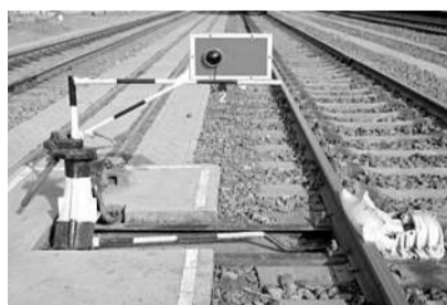
山西大同车务段是大秦铁路的主要源头装车企业之一,担负着同煤集团15家煤矿、72家地方煤矿的煤炭外运任务,年运量5200万吨左右。近几年,该段大力实施“科技保安全”战略,加大科技投入,提升科技手段在作业现场的风险防控作用,研发出手动脱轨器表示器、非集中道岔表示器、带测距功能的信号灯、文电资料命令查询系统,为现场安全提供科技保障。脱轨器表示器可通过室内显示屏监控脱轨状态,非集中道岔表示器可实现远程监控道岔位置,杜绝人为因素造成的安全隐患;带测距功能的信号灯将激光测距仪集成至信号灯内,在不增加调车量的同时,提高作业人员目测停留车位置的精度,克服夜间、降雪及不良天气下的作业限制;文电查询系统集中了行车岗位所有的技术规章、作业流程及调度命令查询等12项功能,实现规章查询电子化。(刘恒斌 高梦璇)
