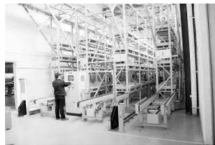
重庆车辆段重庆北动车所为确保春运期间动车检修工作顺利开展,将“智能仓库”投入春运期间动车检修保障工作。该仓库系统主要由高层货架、巷道堆垛机、出入库输送设备、自动控制与管理系统组成,能够在计算机管理下,实现动车检修配件的自动化存取,且能对库存的配件进行自动化管理。
