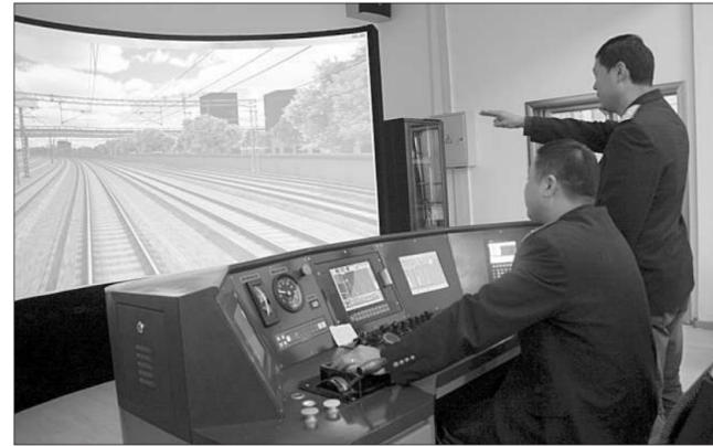
新年伊始,一种新型机车模拟驾驶系统在武昌机务段投入使用。该系统具有实时模拟驾驶机车线路运行环境、状态和信息功能,并且使用方便,教学训练不受时间约束等优点,为火车司机开展模拟驾驶训练、提高驾驶技能及故障处理能力提供了便捷条件。图为该段火车司机正在使用模拟驾驶训练系统进行实操演练。 赵帅民摄
