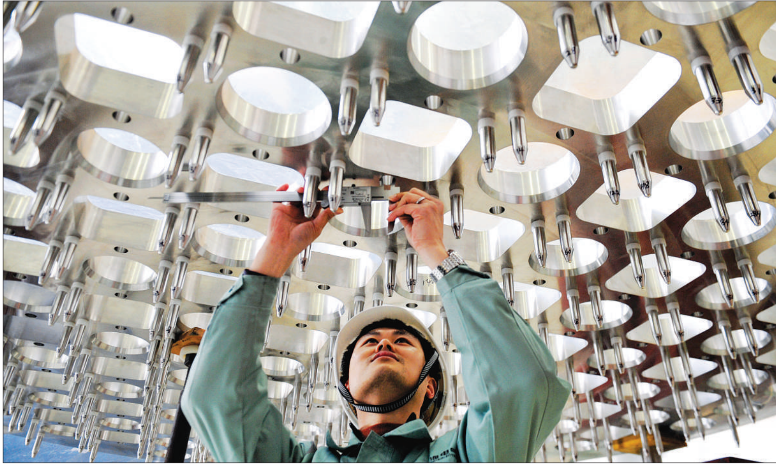
目前,上海正积极发展核电服务新业态,打造面向国内外市场、国内领先、国际一流的核电创新产业基地。上海现有上百家企事业单位从事核研发、设计、科研、设备制造和相关服务。从2007年至今,已累计承接核电装备订单近750亿元,开展核电科研项目90多项,总投资达93.5亿元;累计获授权的发明专利412项,建立了一支近2万人的核电人才队伍;全市形成了三大核电产业基地:上海电气临港装备制造基地、闵行热加工基地、宝钢核电材料基地。 图为上海电气核电集团临港基地的工人在检测核电设备堆芯上板(2月8日摄)。
