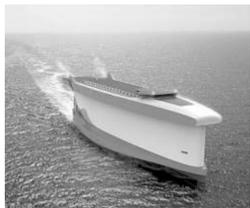
据报道,这艘名为Vindskip的货轮以船身为帆,靠风推动,不需使用燃油,十分节能环保。这艘船体形状十分特殊,在适当的强度和角度,船体可以作为风帆从海风中获取动力持续前进。
