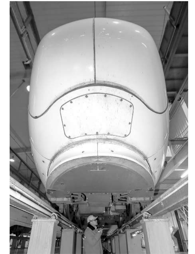
2月4日,工作人员在检测转向架。当日是2015年春运第一天。记者在吉林长春跟随中国北车长春客车股份有限公司工作人员体验了高铁列车检修过程。据介绍,每列高铁列车在结束当日运行后都需入库检修。由6至8名工作人员对制动系统、转向架、牵引网络系统等环节逐一检测,发现问题及时处理,保障运行安全。新华社记者 王昊飞摄
