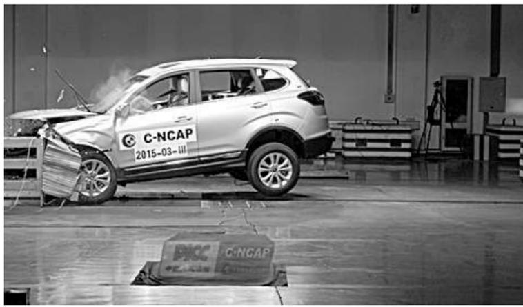
近日,在中国汽车技术研究中心的实车碰撞试验室内,成功完成了奇瑞汽车股份有限公司生产的奇瑞牌SQR6451T217型多用途乘用车(瑞虎5 2.0L手动尊贵版)的正面40%重叠可变形壁障碰撞试验。
