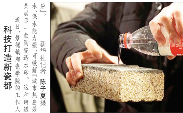
新华社记者 陈子夏摄 水、保水能力强,可缓解城市热岛效应。近日,景德镇陶瓷学院的工作人员展示一款陶瓷透水砖。这种砖透
