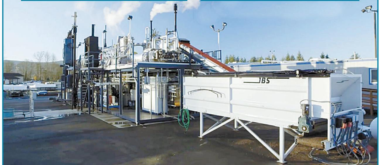
1月9日,比尔盖茨公布了一段视频,视频中他介绍了一种新机器,这种机器能将人的排泄物过滤后净化成饮用水,盖茨饮过后还大赞水好喝。这款装置即将在非洲国家塞内加尔投入试运行,以帮助当地贫困居民喝上干净的水。
