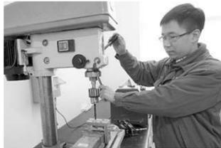
在河北香河县淑阳供电所有一个农电工创新实验室。在这里,10名农电工利用闲暇时间经常聚在一起研究讨论,创新发明出防鸟针板、多功能防水线夹、电子信息杆号牌、锥形电杆杆深测量尺、漏电报警靴等多个实用发明。在创新工作室的带领下,全县农电工队伍掀起了“小改革、小创新和小发明”热潮,加快推进了创新型、技能型和应用型农电工队伍建设。图为国网香河供电公司农电工在制作多功能防水线夹。
