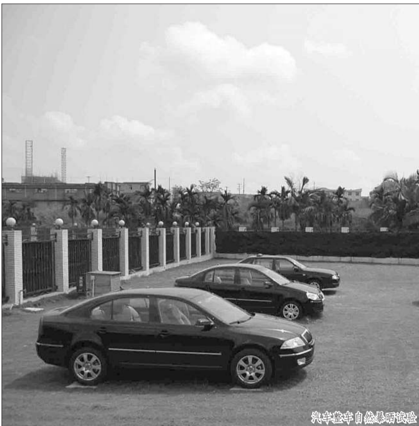
汽车进行自然暴晒试验
