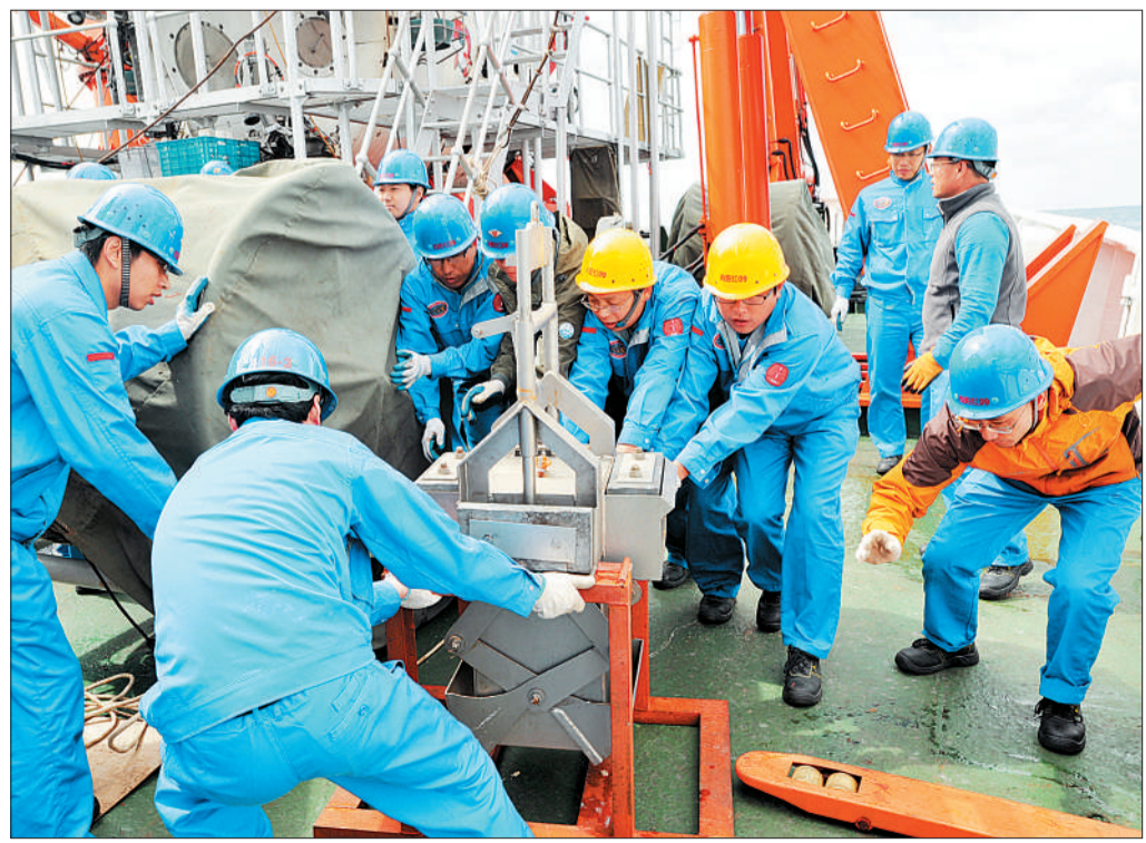
近日,“蛟龙”号载人潜水器所在的作业海区海况较差,科考队员没有浪费珍贵的海上科考时间,抓紧利用重力柱和箱式取样器等开展常规科学调查,在繁忙的科考工作中迎来新的一年。图为“蛟龙”号科考队员正在回收箱式取样器(2014年12月31日摄)。
