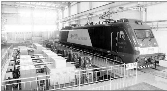
北京铁道所自主研发的国际领先重大装备机车整车动态检测试验系统
