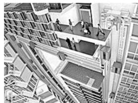
据外媒报道,德国工程和钢铁企业蒂森克虏伯集团日前宣布,在世界上首次开发出了不使用钢缆的电梯系统。该电梯采用线性马达作为动力,可以在上下和水平方向上移动。
