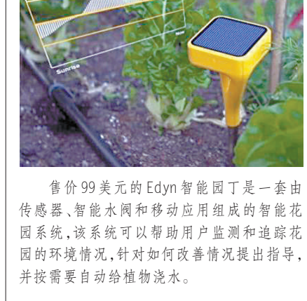
售价99美元的Edyn智能园丁是一套由传感器、智能水阀和移动应用组成的智能花园系统,该系统可以帮助用户监测和追踪花园的环境情况,针对如何改善情况提出指导,并按需要自动给植物浇水。
