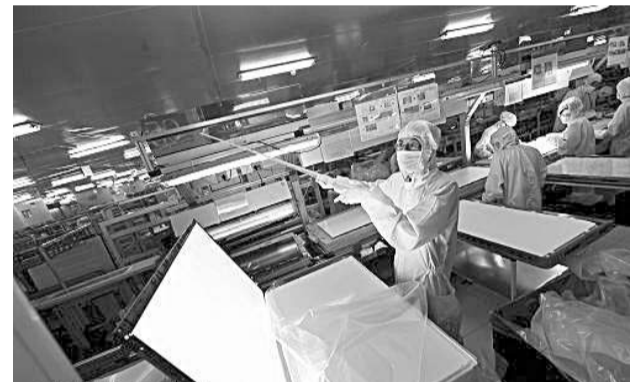
一名工人在海信青岛工厂液晶模组生产车间对液晶面板进行检查
