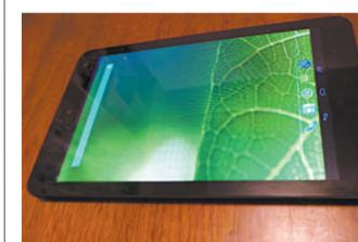
这款万利达石墨触摸屏平板电脑,其突出的特点是采用无锡格非电子薄膜科技有限公司生产的石墨薄膜,以其良好的导电性和超高的透光性,替代了昂贵、易碎、不稳定和生产过程高污染的氧化铟锡(ITO)材料。
