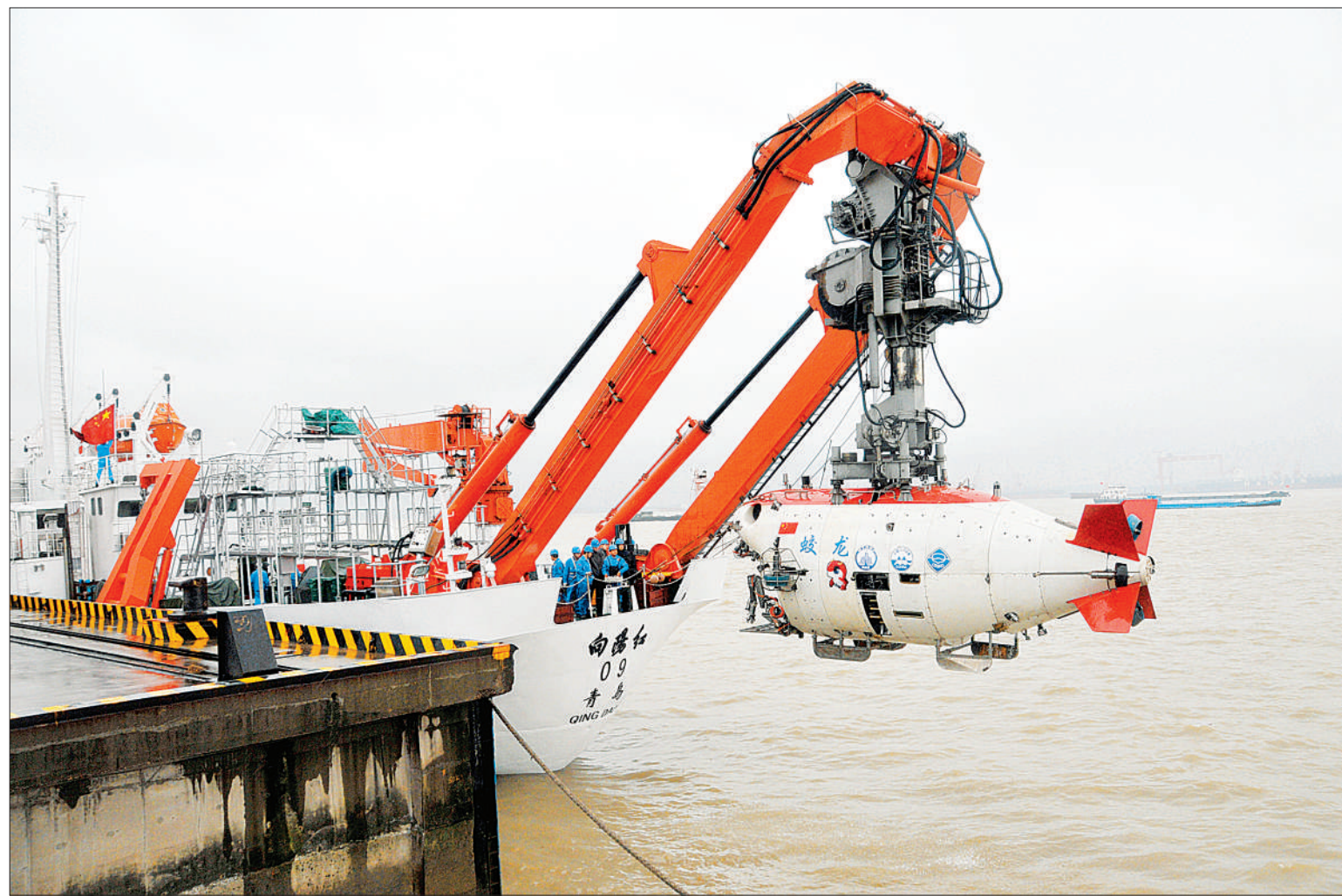
11月24日,“蛟龙”号载人潜水器在江苏江阴南国际码头进行印度洋科考前的最后一次演练。图为母船回收“蛟龙”号载人潜水器。 新华社记者 张旭东摄
