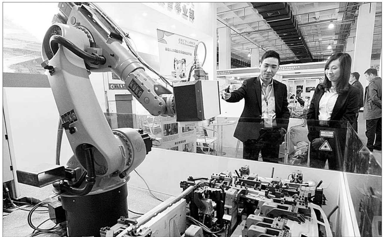
11月21日,2014中国国际汽车制造业博览会在北京举行。展览展示了汽车制造加工领域的新技术和新产品。图为深圳大族激光科技股份有限公司展示的机器人三维激光焊接试验平台。该平台采用激光焊接和激光表面处理工艺,具有节约贵重金属,降低能耗,优化产品结构,提高产品成型率等特点,广泛应用于汽车、航天、船舶、石化、电气等重要国民经济领域。 本报记者 洪星摄
