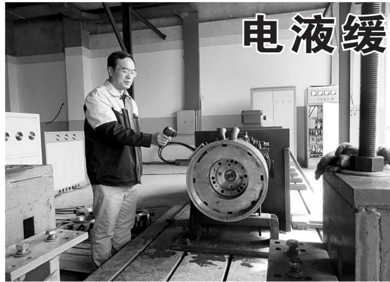
电磁液缓速器(简称电液缓速器),是一种新型汽车缓速器,它是安装在汽车上的辅助制动装置(系统),通过非接触制动,消耗掉汽车行进中或下坡时的动能,达到车辆减速目的。使用汽车缓速器,可有效保障行车安全,减少汽车使用成本,节能环保。
