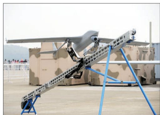
海巡者(灵龙)舰载/车载无人机:先进小型中空近程无人机系统,最大特点就是可采用舰载/车载起飞、垂绳拦阻回收(11月12日摄)。
