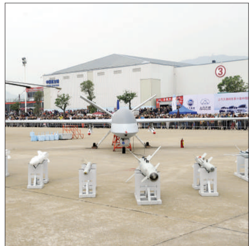
攻击-1无人机:配备光电侦察监视设备和多型武器,目前已形成战斗力,可担负低威胁环境下战场重点区域持久侦察、监视和攻击、毁伤效能评估等任务(11月14日摄)。
