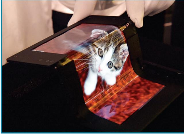
10月30日,日本横滨,显示器创新展上展出一个可以折叠的显示器。这个5.9英寸的显示器由有机发光二极管制成,配备了触屏技术,可以折叠至少10万次。
