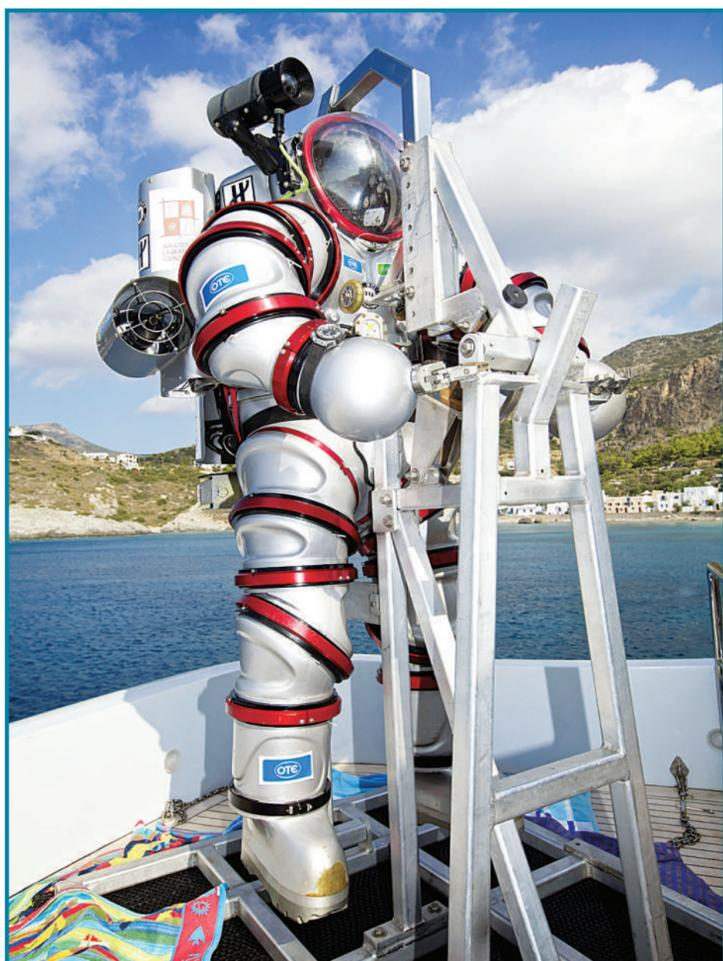
10月4日,希腊Kythera,海洋考古学家身穿先进的深海潜水服Exosuit潜水。Exosuit能够让潜水员的潜水深度提高一倍。
