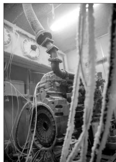
玉柴高效节能环保内燃机国家工程实验室低温试验台架
