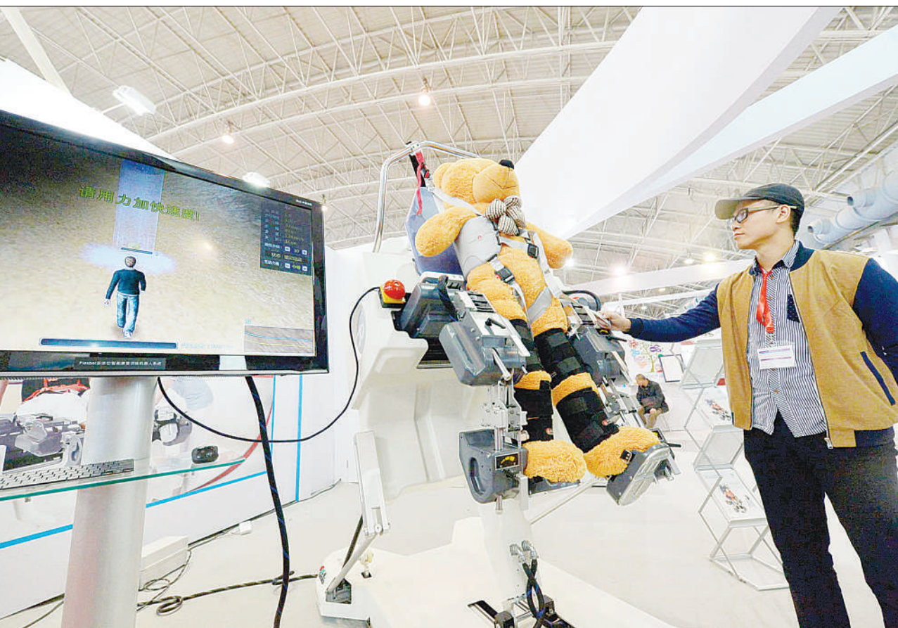
日前,在北京举行的2014中国国际福祉博览会暨中国国际康复博览会上,上海理和技创机器人有限公司展示了具有自主知识产权的多体智能康复训练机器人系统。它可以为残疾人提供个性化训练方案,并提供虚拟步行情景互动训练,具有智能生物反馈,符合人体生理特征等技术特点。
