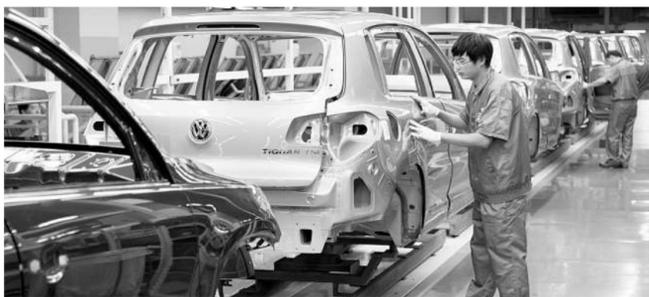
焊接、油漆车间的涂装喷漆、空腔注蜡防腐,以及总装车间的模块化装备,最终经过一系列的严格测试,一辆辆被上海大众认可的汽车才算走完了它的生产之旅。工作人员告诉记者,作为整个汽车生产线的起点,冲压车间主要承担着生产各种上海大众汽车自制冲压件的任务。汽车三厂配备了国际领先的试模压机,所有模具在这里进行研配和调试,以保证所有模具尺寸精准。为了保证车辆的行驶安全,上海大众汽车在与车身安全密切相关的中央通道、四门防撞杆、侧框门防撞板、侧围A/B/C柱等安全件,广泛采用了应用于航空航天领域的热成型工艺,它使热成型高强度钢板抗拉强度较普通钢板强化了近2.5倍,从而最大程度上保障车身强度和安全性。与先进技术和高速运转的自动化生产线相配合的还有身手敏捷的“机械帮手”“KUKA机器人”。这些先进的工艺不仅保证了整线可以实现连续、快速、多品种柔性化生产,还极大地提升了生产效率,更加的环保和节能。
