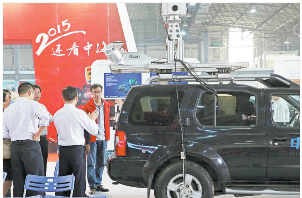
10月25日,以“转型升级,振兴产业”为主题的第四届全国地理信息技术装备展在南昌国际展览中心举行。据悉,众多国产自主研发设备在本届展会上首次公布。图为参观者在参观一款车载激光扫描系统。新华社发(万象摄)
