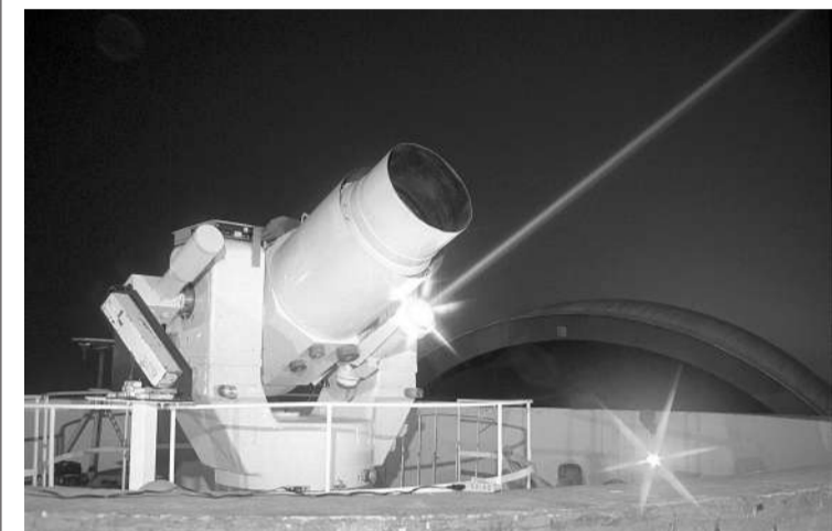
1994年10月测绘研究院自行研制的第三代人卫激光测距仪
