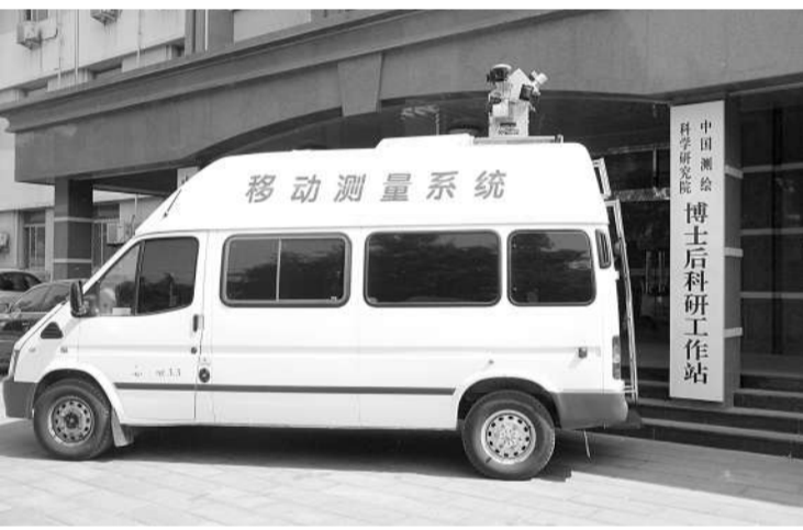
2012年测绘研究院自主研制的SSW车载激光建模测量系统
