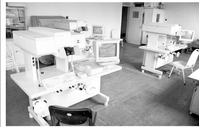
1999年测绘研究院研制成功的解析测图仪
