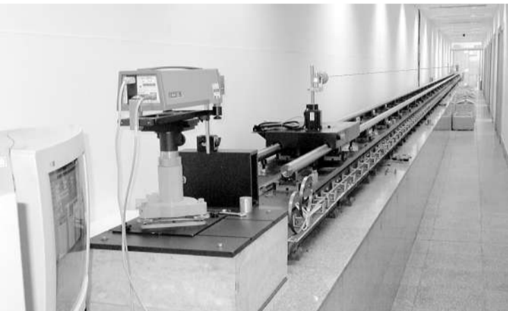
2005年测绘研究院自主研制的国内首套大长度实验室全自动化检测系统
