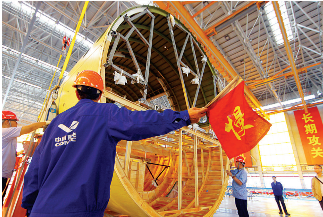
近日,C919国产大型客机首架机头大部段运抵中国商飞公司总装制造中心浦东基地,即将进入机体结构对接程序,同机身进行对接。工作人员在吊装C919大型客机首架机头大部段。新华社发
