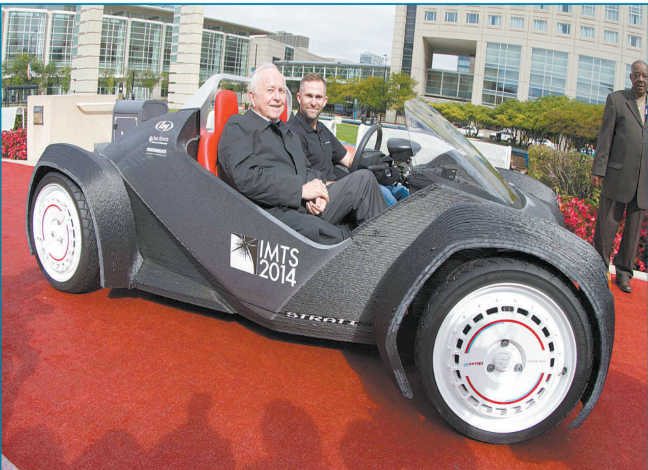
▼美国芝加哥,世界上首个3D打印制造的电动汽车Strati。该车有近50个不能移动、不用清洁和不导电的零部件全部使用3D打印技术制造。此外,其使用的整车一体打印,也是首次被用于汽车制造业。
