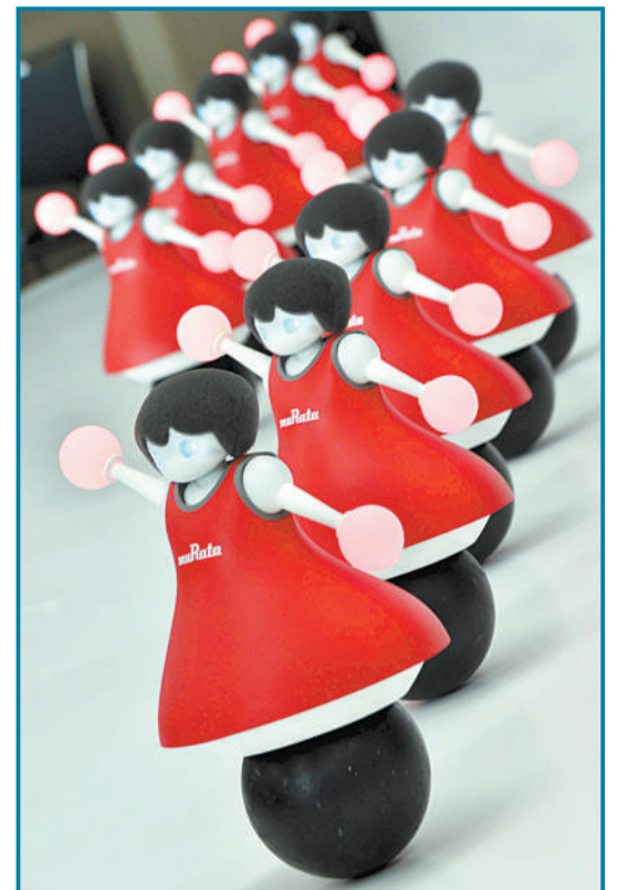
▲9月25日,日本东京,日本株式会社村田制作所正式公开展示的第四代机器人啦啦队。该机器人通过最新的传感、通讯及群控技术使机器人在运动中具备很高的稳定性及协调性。
