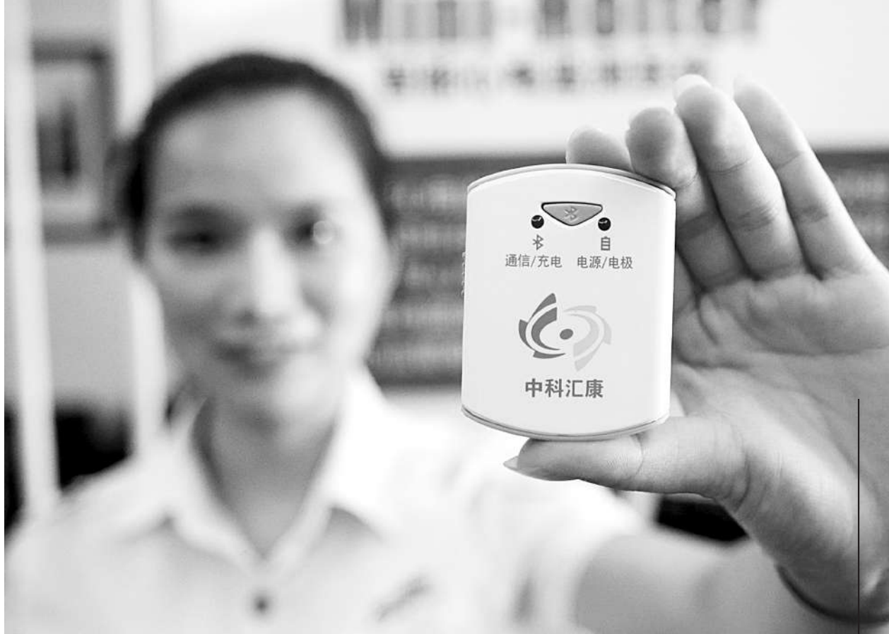
9月26日,由中国科学院先进技术研究院研发的目前国内最小的mini-holter智能心电图监测系统设备在湖北省问世。该设备直径仅为5厘米,大约半张银行卡的大小,可以对人体心脏和血管的24项核心指标和数据进行连续性长期监测与记录,并能通过无线网络上传至后台服务器,进行有效的数据分析和专家会诊。
