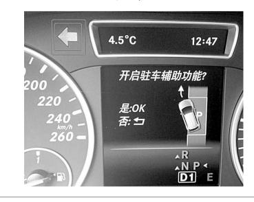
新上市的2015款奔驰C级全系配备了自动泊车系统。这套自动泊车功能是由前/后探测雷达、泊车辅助控制单元、电动助力转向系统、自动变速箱、刹车系统和行车电脑等元件来共同实现的,这套系统可以实现侧向和垂直两种停车方式。另外,侧向停车后还支持侧向自动使出功能,但垂直停车后不支持自动
