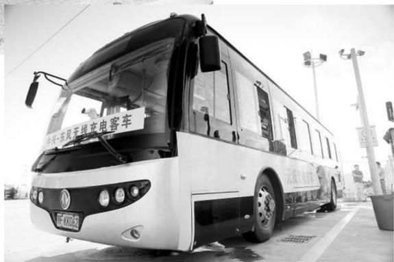
9月17日,中兴通讯联手东风汽车联手打造的全球首例无线充电公交示范线在湖北襄阳启动。此次投入运行的公交车无线充电装置总功率为60千瓦,每分钟可充6度电。目前该市已开通5条纯电动公交线路,单程距离为17公里,有线充电桩充电每次需五六个小时。无线充电装置投入运行后,理论上充4分钟就可跑完单程。无线充电技术只需将电磁感应器埋在地下,再在新能源公交车上安装接收器。车开上去自动充电,车离开后,又自动关闭。图/CFP
