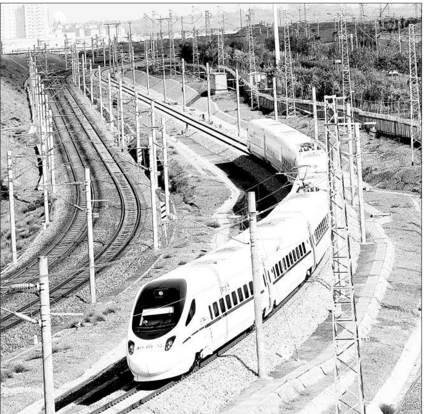
9月21日起,乌鲁木齐动车运用所与乌鲁木齐铁路枢纽兰新客专(即兰新高铁第二双线)相关工程全面进入联调联试。乌鲁木齐动车运用所是新疆目前唯一一座动车运用所,建成规模为动车检查库6条,存车线36条(预留12条),是一个巨型的动车停车场,其规模、功能、建设标准均居国内已投入使用动车运用所前列,也是新疆唯一的“动车之家”。图为9月22日,一列CRH5H型动车组行驶在乌鲁木齐动车运用所至乌鲁木齐新客站过渡站区间进行信号系统联调联试。 新华社发(王生政摄)
