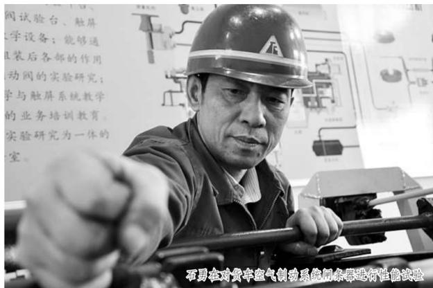
石勇在对货车空气制动系统阀类零件进行性能试验。
