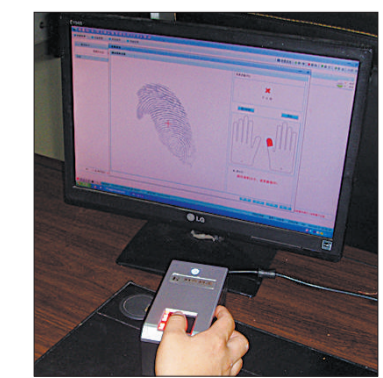
近日,一台先进的人体指纹采集仪配备在江苏四仰山边防所。该仪器通过采集棱镜将指纹呈现于图像传感器,提高了指纹采集精度。(陈海)
