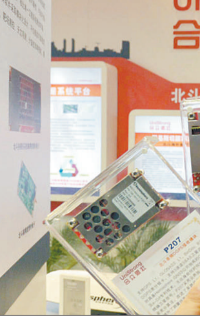
9月11日，第三届中国卫星导航与位置服务年会暨展览会在北京会议中心开幕。图为北京合众思壮科技股份有限公司推出了北斗高精度核心部件板卡，主要应用于电力、通讯、高精度测量、无人驾驶车辆导航等领域，具有精确、可靠、抗干扰等特点。 本报记者 洪星摄
