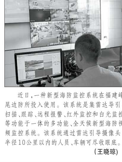
近日，一种新型海防监控系统在福建靖边边防所投入使用。该系统是集雷达引导、扫描、跟踪、远程报警、红外监控和光电监控等功能于一体的多功能、全天候新型海防视频监控。该系统通过雷达引导摄像头，半径10公里以内的人员、车辆可尽收眼底。（王晓琼）
