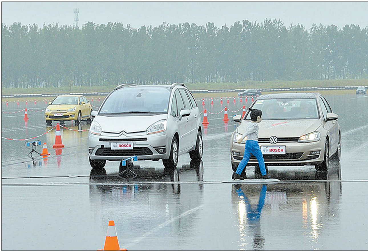
9月2日,汽车技术与服务供应商博世公司,在连云港举办首届“博世汽车技术创新体验日”活动。活动中,博世展示了清洁动力、安全技术、自动驾驶、车联网以及售后市场等领域的创新与本土化解决方案。图为现场模拟城市道路儿童横穿马路突发情况发生时,装有博世研发的行人预碰撞系统的汽车实行自动紧急制动的瞬间。(袁寅光)
